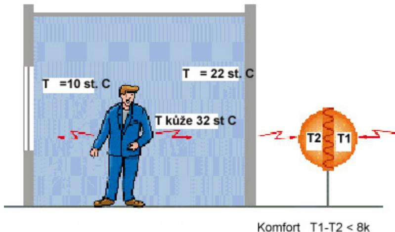
Výše teploty naměřené na polosféře kulového teploměru závisí na teplotě zdroje a na vzdálenosti mezi zdrojem a bodem měření.
