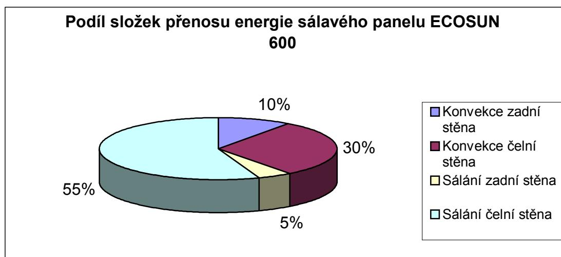
U vysokoteplotních panelů je pásmo účinnosti přeměny celkového příkonu v sálavou složku cca 60 – 70 % dle typu panelu.
